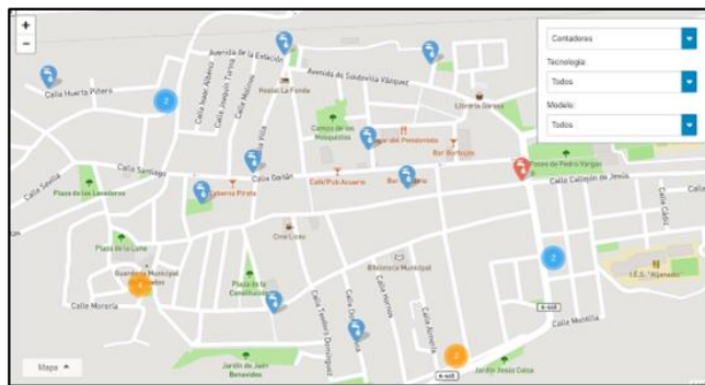
Figura 2. Localización de los contadores e incidencias. En la plataforma se representa la localización de los contadores con el símbolo de un grifo y una gota, el color del fondo indica su estado: azul para perfecto funcionamiento y rojo para incidencia. Además, para no tener un gran número de puntos en pantalla los agrupa por cercanía, estos los representa en esferas con un número, el cual nos indica los contadores dentro de ella, la tonalidad de estos nos indica el estado de los contadores agrupados: azul, para 0% incidencias, naranja, para al menos una incidencia y rojo para 100% de incidencias.
